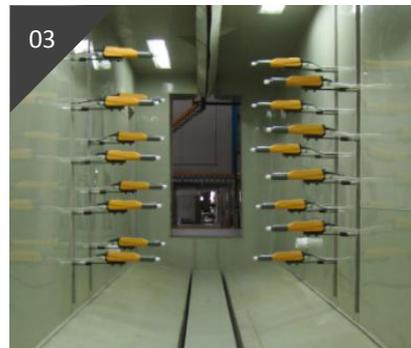
喷房系统可根据喷粉方式和要求有不同粉末回收设计，主要有大旋风，小旋风和滤芯回收几种方式。
