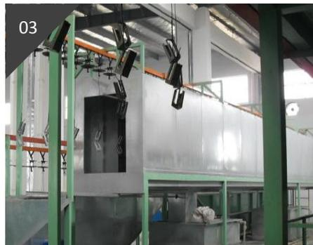
前处理有多种处理方式，通常有喷淋、浸泡、油浸。其目的是除去工件表面油污、锈蚀并形成一层保护膜。
