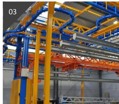
输送机根据所承载的产品分重型和轻型结构，链条有标准5T链、十字链、模锻链和积放链等选择。
