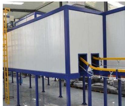
粉末固化炉可分为在线固化和离线集中固化形式，加热方式通常有天然气、柴油和生物颗粒燃烧机等。
